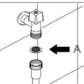
Гидравлические трубы и кабель электро питания выведены в задней нижней части справа. Подключить трубу гидро питания к гнезду с разъемом с резьбой  $\frac{3}{4}$ " gas, вставляя фильтр A в оборудование (в моделях с аквастопом фильтр и зажимное кольцо образуют единую деталь). Для подключения к водопроводу используйте только новые трубы; нельзя использовать старые или б.у трубы
