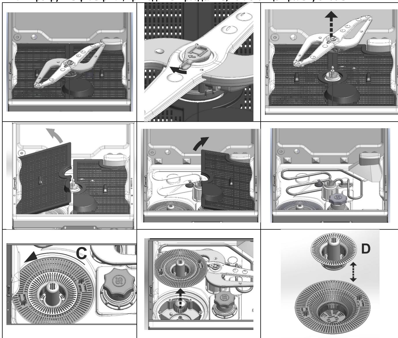
Процедура демонитрования фильтров с двумя фильтрующими элементами:
