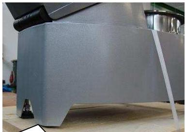
Если машина плохо установлена, отрегулируйте заднюю ножку
