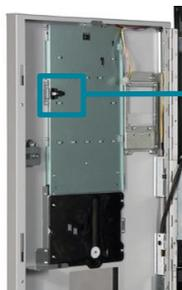
Защелка для доступа к кнопочной панели.
