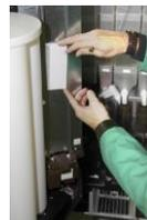
**6th.** Поместите мешок для отходов в корзину и убедитесь, что канистра для жидких отходов находится на своем месте, трубка слива отходов должна входить в канистру и поплавков должен висеть внутри нее.
