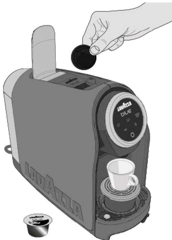
**4** Опустите рычаг для загрузки капсул, чтобы закрыть углубление для установки капсул.
