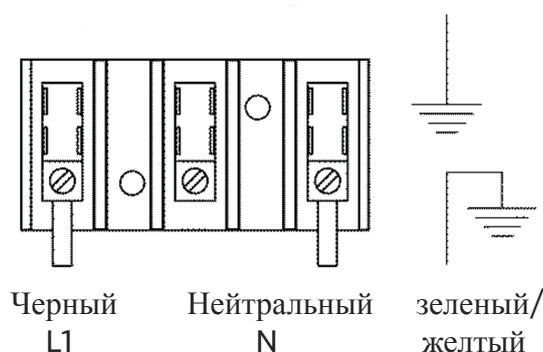
**ПРИМЕЧАНИЕ.** Эта электрическая сеть состоит из 2 токоведущих проводников (L1 и нейтраль) и отдельного проводника для заземления.
