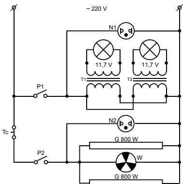
T<sub>1</sub>, T<sub>2</sub> - трансформатор света
