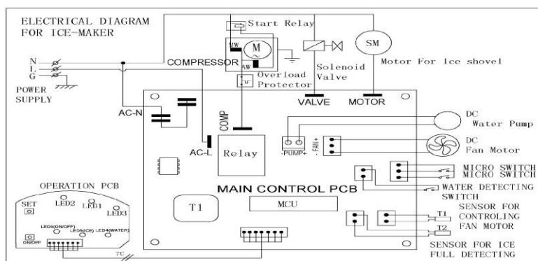
Start relay – реле запуска, Compressor – компрессор, Power supply – источник питания, Operation PCB – управление печатными платами, Main control
