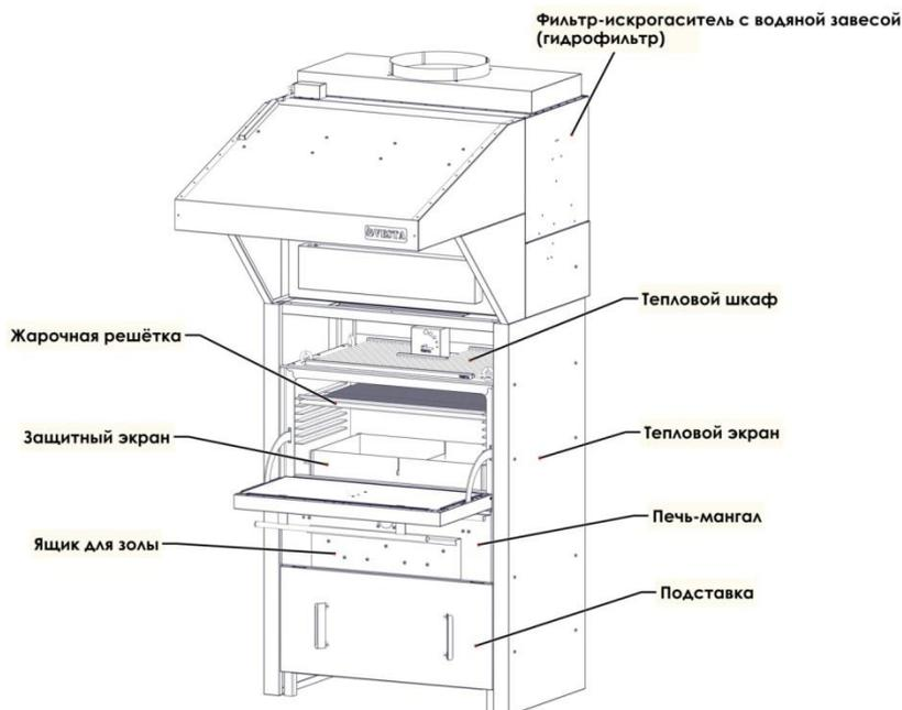
Предлагаются четыре модели печи-мангала. Цифра в названии модели говорит о площади жарочной решетки в дм<sup>2</sup> (округленно). Каждая из моделей может быть представлена с жарочной камерой из черной стали повышенной жаростойкости толщиной 6 мм или с жарочной камерой из жаростойкой нержавеющей стали толщиной 6 мм (в этом случае к названию модели добавляется литера (N)).
