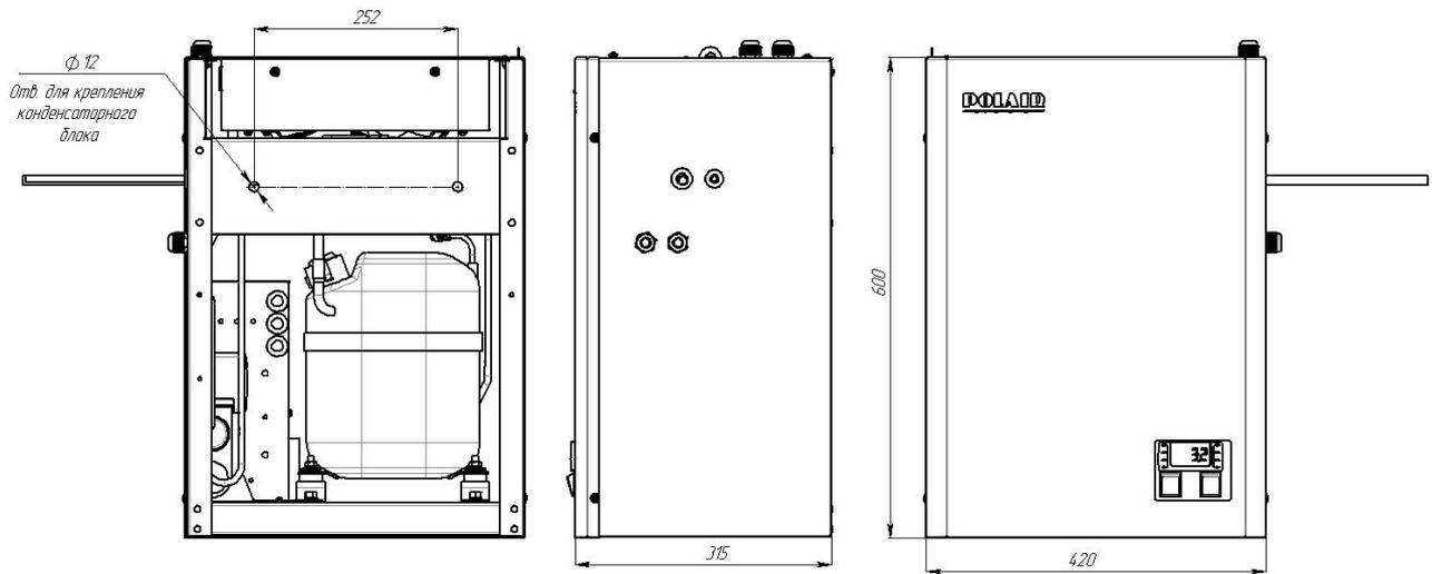
**Рис.5** Габаритные и присоединительные размеры конденсаторного блока сплит-систем второго габарита
