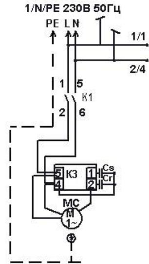
1. Соединительный кабель: 1 и 2 - ТЭНы(черн.), 3 и 4 - эл.двигат.(синий и коричн.), 5 - заземление (ж/з).
