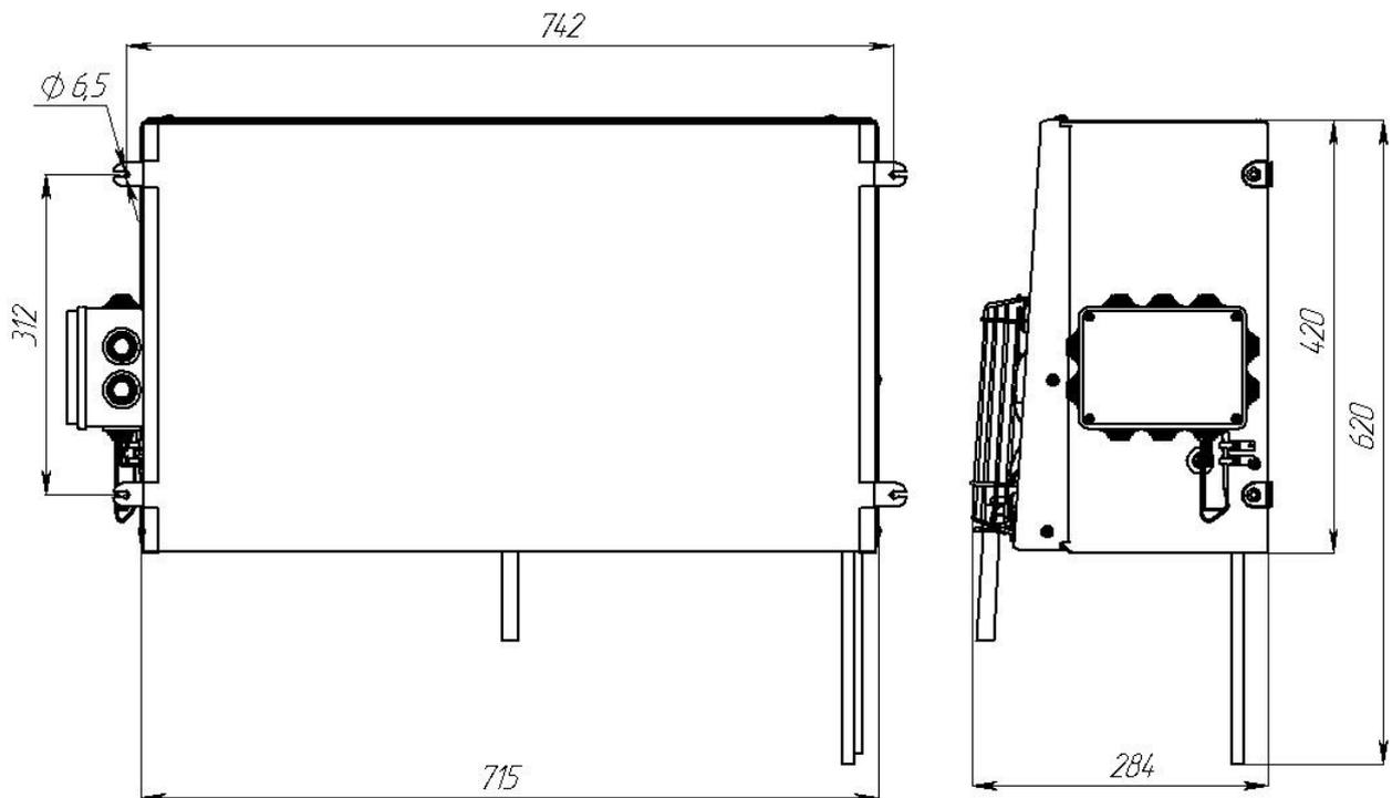
**Рис.4** Габаритные и присоединительные размеры конденсаторного блока сплит-систем первого габарита
