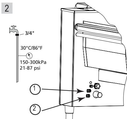
Мы рекомендуем Вам установить на каждый аппарат по одному запорному шаровому крану. Перед подключением аппарата Вам необходимо прочистить и продуть трубопровод.
