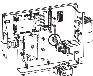
На моделях 211/311 рядом с главным контактором предусмотрена специальная розетка. Вы можете подключить кабель Ethernet, прямо на разъём RJ45.
