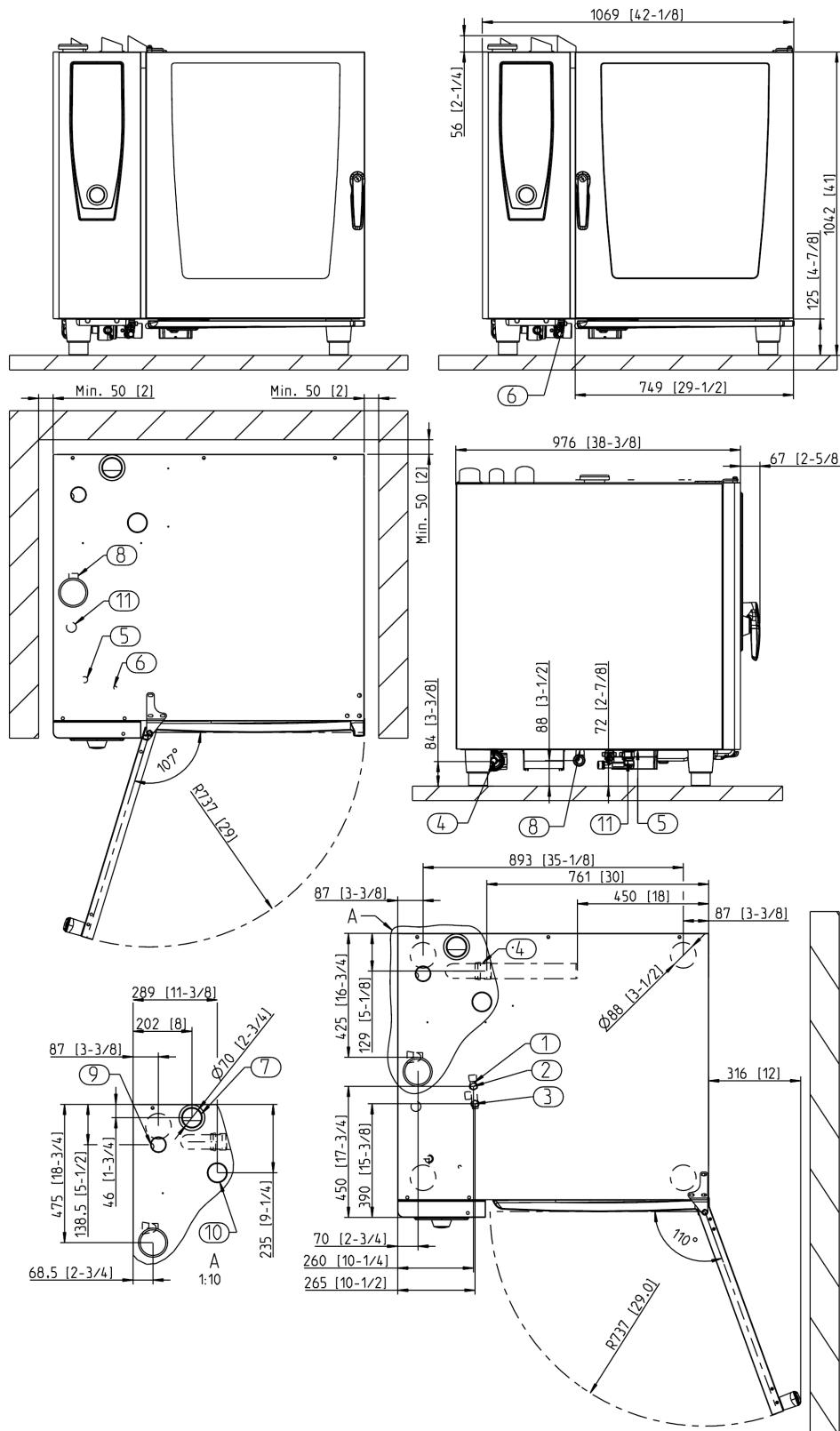
1. Общая труба подачи воды (холодная вода) 2. Труба подачи холодной воды 3. Трубы подачи умягчённой или горячей воды 4. Отвод воды 5. Подключение к электросети 6. Уравнитель потенциалов 7. Вытяжная труба DN 70 8. Подключение к газовой сети 3/4" 9. Вытяжная труба (пар) 10. Вытяжная труба (горячий воздух) 11. Влагозащищенный разъем RJ45; Минимальное расстояние 50 мм Размеры в мм (дюймах)
