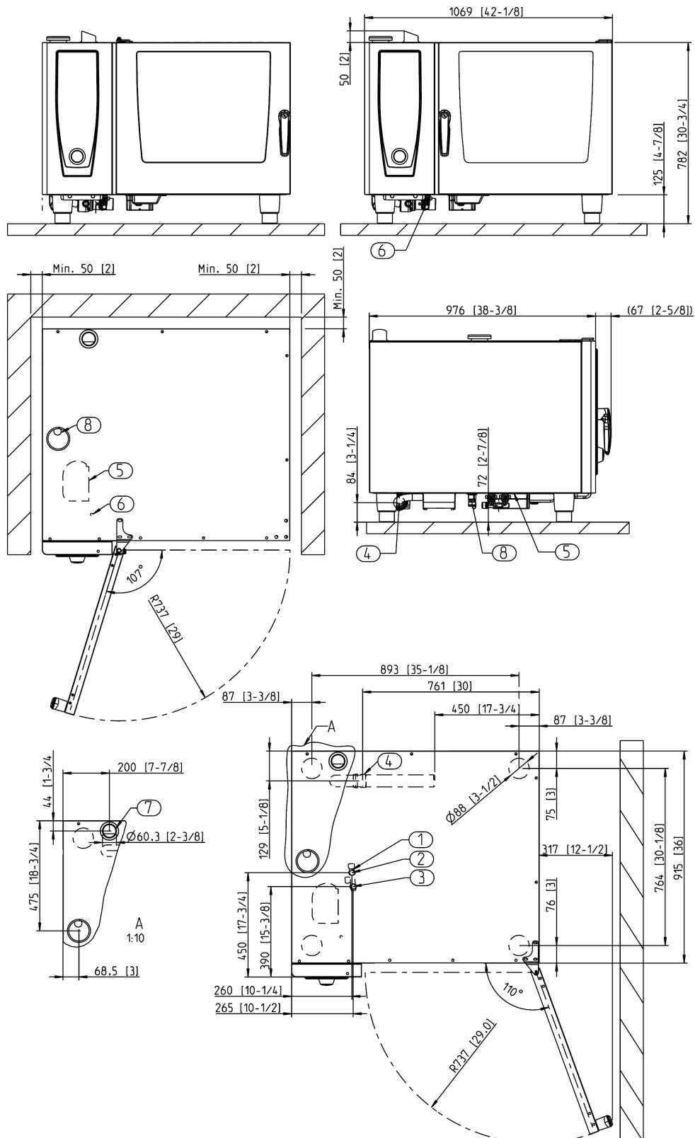
1. Общая труба подачи воды (холодная вода) 2. Труба подачи холодной воды 3. Трубы подачи умягчённой или горячей воды 4. Отвод воды 5. Подключение к электросети 6. Уравнитель потенциалов 7. Вытяжная труба DN 60 8. Влагозащищенный разъем RJ45; Минимальное расстояние 50 мм Размеры в мм (дюймах)
